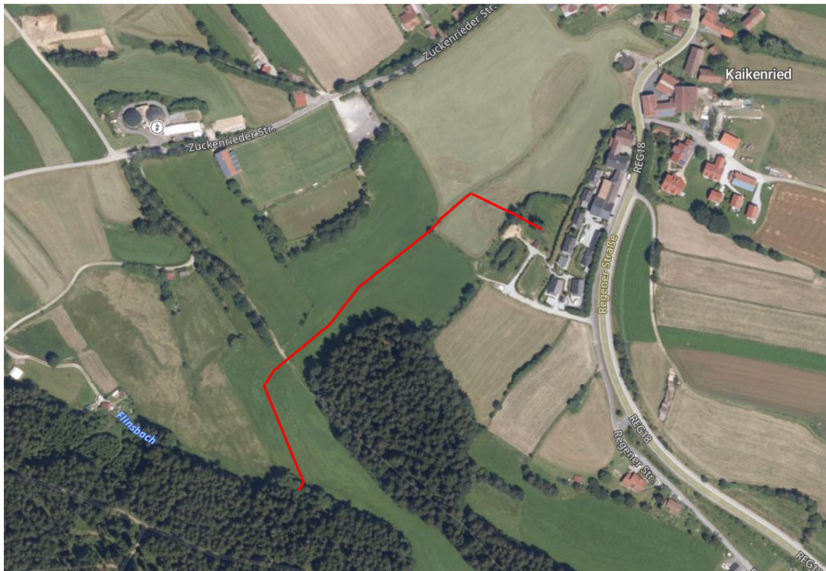
Abb. 3 Darstellung der Oberflächenentwässerung über bestehendes Grabensystem (teilweise verrohrt).
