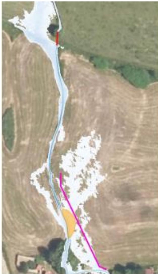
Abbildung 1-5: Wassertiefe  $H_{Q_{100}}$  Ist-Zustand inkl. Durchlässe (rot), Lage der Geländemodellierung (magenta) und Bereich der Uferabflachung (orange), (Bereich Baugebiet)
