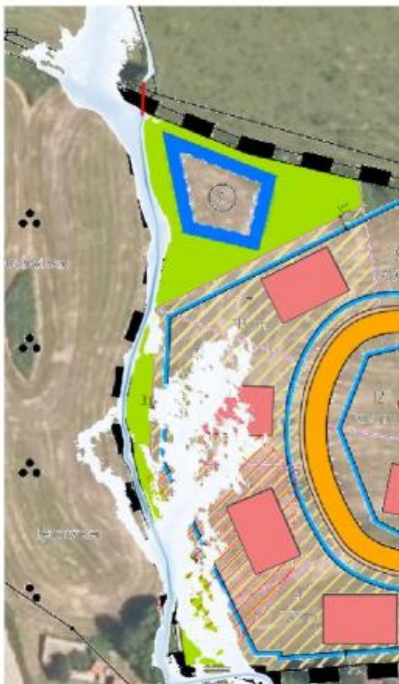
Abbildung 9: Wassertiefe HQ<sub>100</sub> Ist-Zustand inkl. Durchlässe (rot), (Bereich Baugebiet)
