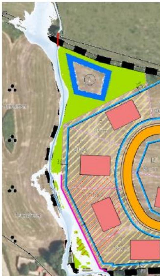
Abbildung 17: Wassertiefe HQ<sub>100</sub> Geplanter-Zustand (Bereich Baugebiet), Beginn Geländemodellierung (momentan)
