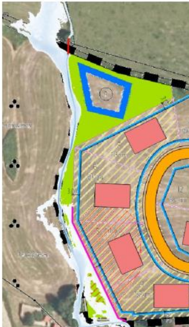
Abbildung 17: Wassertiefe HQ 100 Geplanter-Zustand (Bereich Baugebiet), Beginn Geländemodellierung (momentan)
