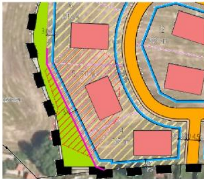
Abbildung 13: Lage der ins Modell integrierten Mauer bzw. Böschungsfußpunkt der späteren Auffüllung (magenta)
