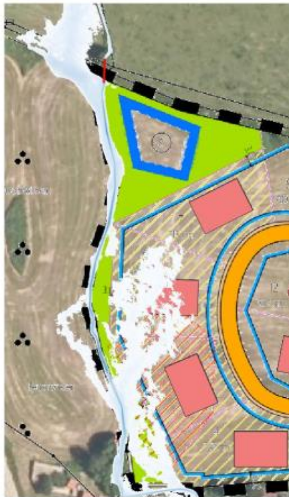
Abbildung 9: Wassertiefe HQ100 Ist-Zustand inkl. Durchlässe (rot), (Bereich Baugebiet)
